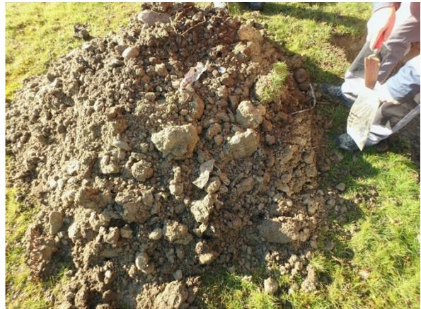
Abbildung 4: Schutzdamm Südost, Lage P3, mit Fremdstoffen belasteter Bodenaushub samt Probenahme.
