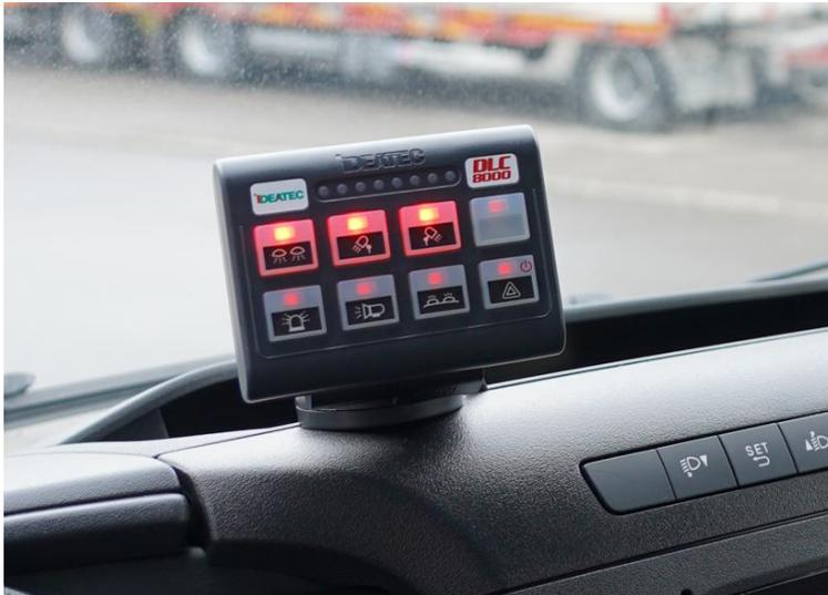
Das programmierbare Canbus-System ist die neueste Generation von Bedieneinheiten, welches über eine PC-Schnittstelle frei programmiert werden kann. Die Tastatur hat eine Hintergrund- und Funktionsbeleuchtung, die Symbole können frei gewählt werden (mit 64 mitgelieferten Tasten-Piktogrammen).
