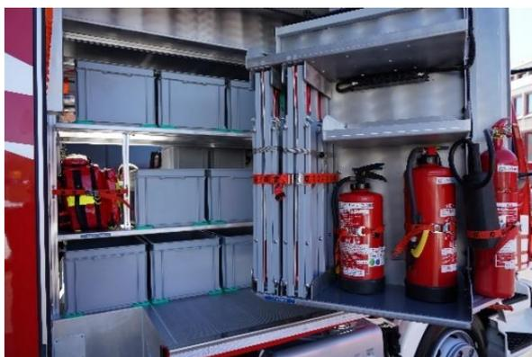
Durch das umfangreiche Halterungssystem Rosenbauer COMFORT werden die Gerätschaften geeignet gesichert. Das Halterungssystem orange ermöglicht das schnelle und einfache Entnehmen der Ausrüstung. Ein einheitliches Farbkonzept erleichtert die Arbeit zusätzlich. Alle bedienbaren Elemente sind deutlich durch die Farbe Orange gekennzeichnet.
