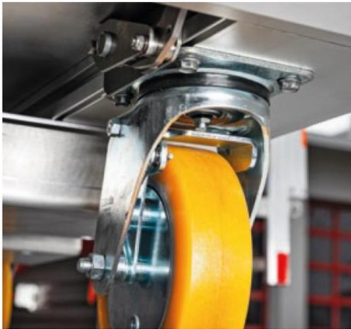
Um einen Rosenbauer Rollcontainer in Bewegung zu setzen, muss lediglich die orange Griffstange nach unten gedrückt werden. Das funktioniert wegen des geringen Widerstandes mit minimalem Kraftaufwand und dank Einstangenmechanik auch ohne gespreizte Finger - für eine komfortable und möglichst mühelose Bedienung. Wird die Griffstange losgelassen, klappt diese automatisch nach oben, verschwindet im Korpus und der RTE RC Profile kommt.
