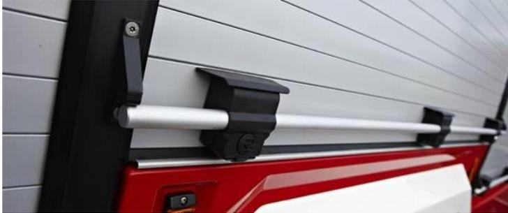
Die Rolläden sind aus biegesteifen Alu-Hohlprofilen mit Gummidichtungen und werden auf eine speziell ausgelegte Federwalze aufgerollt. Durch die Gummidichtungen schliessen die Rolläden staub- und spritzwasserdicht ab. Die Produktion findet im eigenen Komponentenwerk Neidling bei St. Pölten (Österreich) statt.
