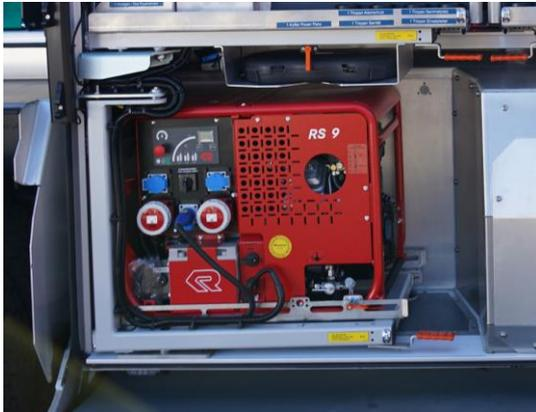
Frequenz 50 Hz, Motor B&S 16 PS mit E-Starter für den Fahrzeugunabhängigen Betrieb, Robuster Rohrrahmen, Tank mit 10.5 Liter Inhalt. Ein Betrieb ab externem Kanister (Ansaugen) ist problemlos möglich. Schallarmer Auspufftopf reduziert die Geräuschentwicklung
