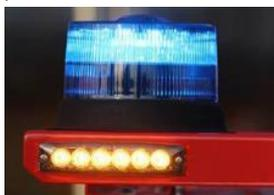
Die Warnblinkleuchten sind auch bei geöffneten Heckflügeltüren gut sichtbar.
