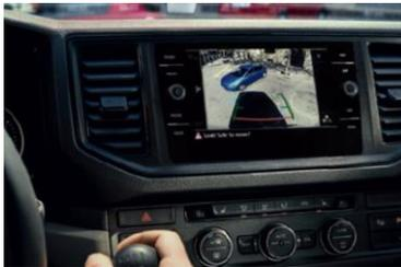
Originale Rückfahrkamera am Heck oben mit Bildübertragung auf originalen Bildschirm in der Fahrerkabine, Optimale Bildübertragung auch bei Dunkelheit, Rückfahrkamera wird beim Einlegen des Rückwärtsganges automatisch aufgeschaltet
