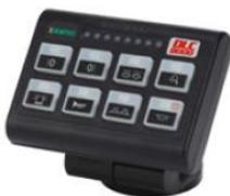
Das programmierbare Canbus-System ist die neueste Generation von Bedieneinheiten, welche über eine PC-Schnittstelle frei programmiert werden kann und die Blitzleuchten, Feuerwehrhorn etc. ansteuert. Bis zu 50 Stück statisch gesicherte Ausgänge. Die Tastatur hat eine Hintergrund- und Funktionsbeleuchtung, die Symbole können frei gewählt werden (mit 64 mitgelieferten Tasten-Piktogrammen). Die Bedieneinheit ist zentral am Armaturenbrett befestigt.
