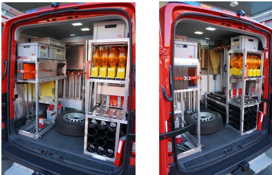
Die Halterungen werden ausschliesslich aus ALU-Profilen, ALU- Blechen und Kunststoff gefertigt. Der Einbau vom Feuerwehrmaterial erfolgt nach vorangehender Einbaubesprechung in unserer Werkstatt in Oberglatt.
